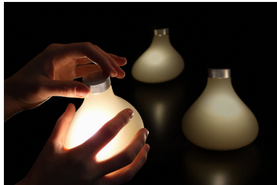
FIGURE 6.4 – Share AWARE Light [20], un SIP pour la sobriété énergétique utilisant un afficheur ambiant fixe qui permet de partager de l'énergie entre habitants. Lorsque la luminosité d'une lampe de Share AWARE Light est trop augmentée, celle des autres lampes baisse.
